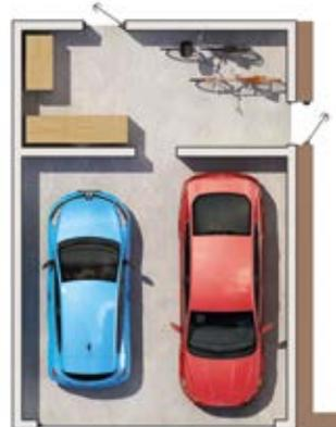
**Doppelgarage** ohne Trennwand mit großem Sektionaltor mit rückseitigem Geräte- und Abstellraum mit Trennwänden zum Garagenraum. An der rechten Seite Durchgang zum Wohnhaus.
